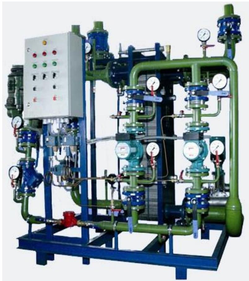
**Рисунок 8. Внешний вид модульного ИТП**
